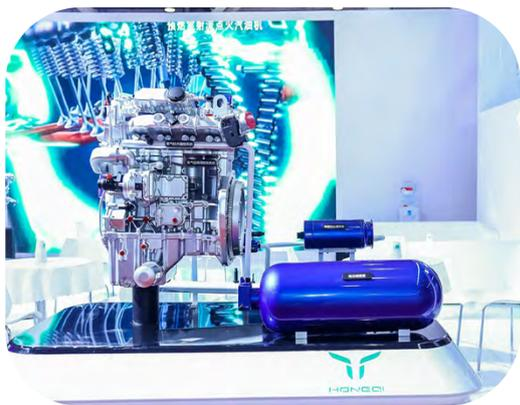
作为红旗自主混动车型的旗舰动力，其在经济性、轻量化、精益化设计、NVH、成本优化等维度全面提升，压缩比提升 13%，摩擦功率降低 28%，最高热效率达到 44.42%。
