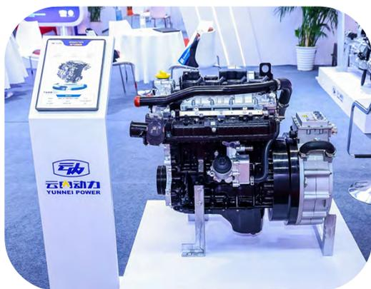
**G20TNFR 燃气增程器**是云内动力推出的一款高效、节能的新能源产品，针对 4.5 吨至 18 吨车辆应用场景，实现混合动力增程路线。该燃气增程器的气电转化效率高、动力强劲，相比较传统燃油混动具有更低的运行成本与污染物排放，较纯电动系统具有更长的续航里程和充能效率。这款燃气增程器最大输出功率为 140 马力，额定扭矩 350 牛米，电压平台 540V，电机效率高达 96%，该燃气增程器的发动机还创新性地融入了中置双 VVT 技术，进一步优化进气和排气系统，从而提升发动机的动力性能，同时实现更高的热效率。
